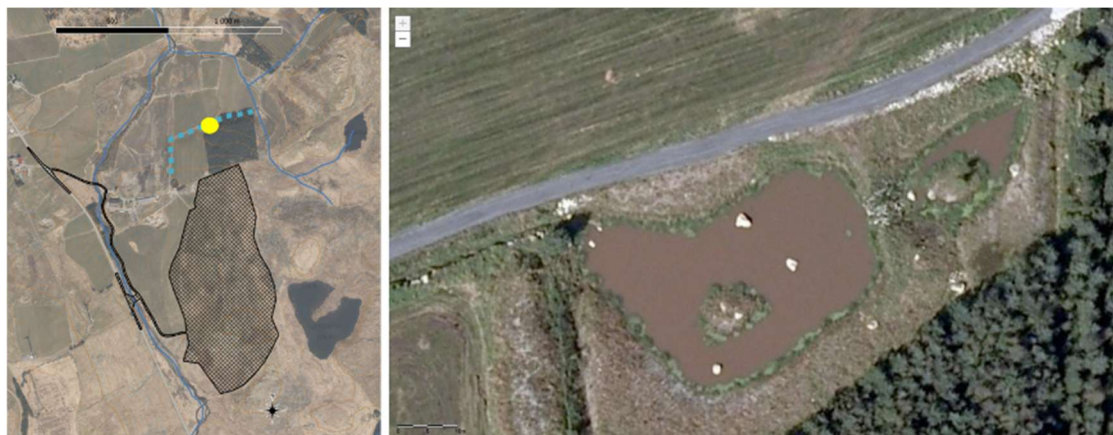
Figur 9.7. Renseparken som er anlagt nord for planområdet (gul prikk) er tilknyttet eksisterende grøfteløp (turkis stiplet linje) nedstrøms planområdet. Dammen har en todelt utforming, slik bildet (t.h.) ved ferdigstilling i 2007 viser (Norgeibilder.no).
